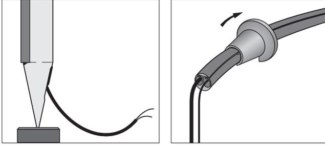
غطاء الكابيل: الأنبوب المطاطي المرقق مع السماعات هو غطاء كابل مصمم خصيصًا للسماعات. استخدم الأداة المرफقة "لقفل" غطاء الكابل عندما تضع سلك التيار الكهربائي وكابل Power Link كليهما داخله.
