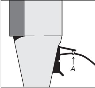
لأغراض السلامة يجب عليك تثبيت سلك مصدر التيار الكهربائي بالغطاء الأسود مستخدمًا رابط الكابل (A) المرفق.
